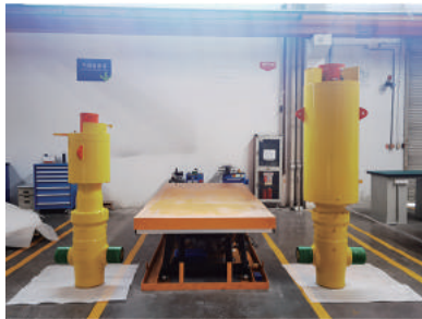
典型取证：3000m水下深水阀门样机认证——ROV驱动和液动
